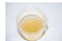
① 将明胶倒入15倍量的水中溶胀30分钟后, 60°C水浴至溶解。
